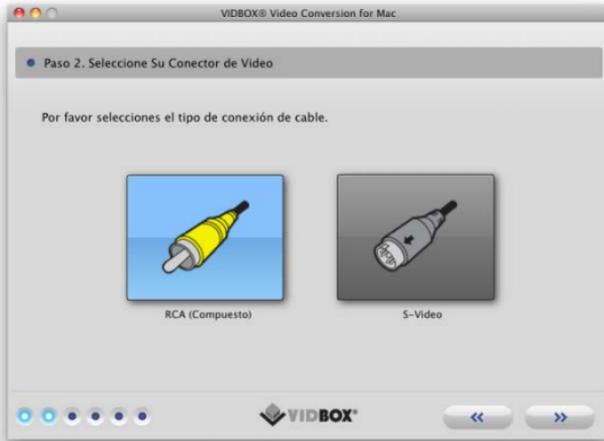
\*Los cables S-Video transmiten una señal de video de más alta calidad que los cables RCA (Compuestos) pero no transmiten la señal de audio. Aún se requieren los cables RCA (Compuestos) cuando se utiliza una conexión tipo S-Video.
