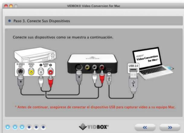
Las conexiones con cables S-Video y RCA (Compuestos) para audio se muestran a continuación.
