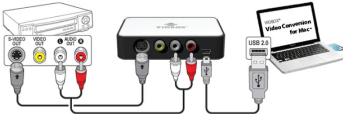
Consejo: Es importante que se conecte el dispositivo de captura a su computadora antes de abrir la aplicación Video Conversion for Mac para asegurar que se detecte adecuadamente el dispositivo.
