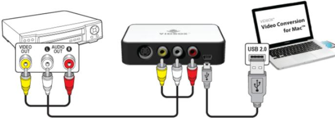
Las conexiones de su reproductor de video se pueden hacer vía cables (compuestos) RCA (arriba) o con una combinación de cables S-Video y RCA (Compuestos) para audio (abajo).
