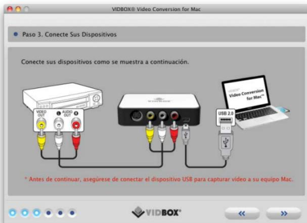
Las conexiones de los cables RCA (Compuestos) se muestran arriba.
